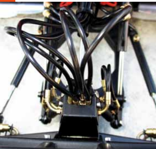
Es wird eng im vorderen Hydraulikverteiler
