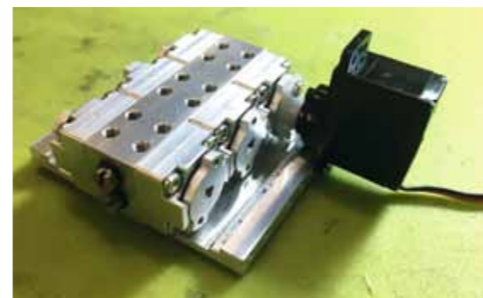
Der Ventilblock samt Servohalterung. Alles muss genau den beengten Platzverhältnissen angepasst werden
