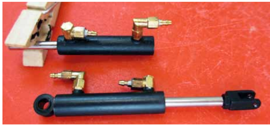
Die Seitenfinisher-Zylinder mit gegossenen Anschlüssen. Auch diese sind so originalgetreu wie möglich
