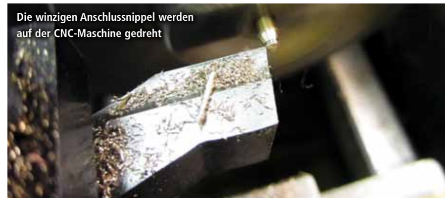
Die Anschlussnippel sind aus Messingdraht mit 2 Millimeter Durchmesser gefertigt
