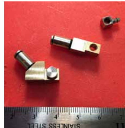
Für den Hochdruckschlauch wurden spezielle Anschlüsse hergestellt
