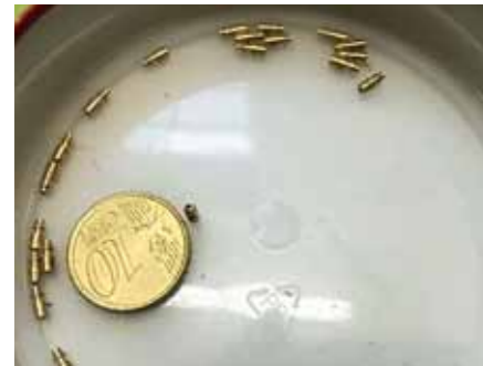
Die Anschlussnippel sind aus Messingdraht mit 2 Millimeter Durchmesser gefertigt
