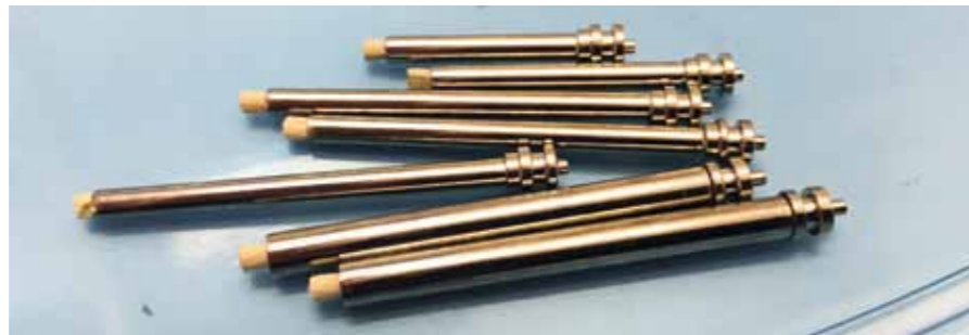
Die Kolbenstangen noch vor dem Vernickeln
