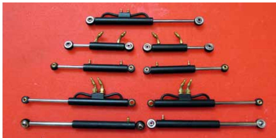
Der einbaufertige Hydraulikzylinder-Satz, von oben nach unten: Neigen, Tilten, Schild-Seitenteile, Hub und Schwenken
