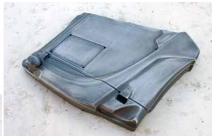
Die Entlüftungsbohrungen für den Tiefziehprozess sind hier gut zu erkennen
