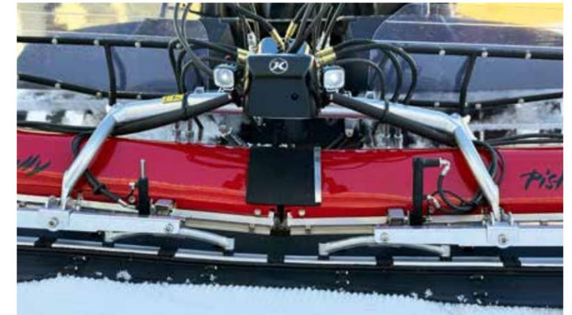
Zentraler Hydraulikverteiler und Klappenzyylinder an der Heckfräse
