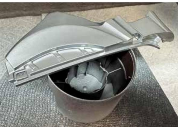
Grundierung der Druckteile mit Silberlack als UV-Schutz
